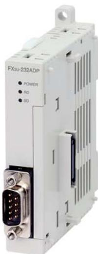
FX3U-232ADP можно подключить к левой стороне ПЛК через левую расширительную шину. Для этого модуля может потребоваться специальный код языка релейных диаграмм и/или настройка параметров в ПЛК, чтобы конфигурировать порт связи. Данные могут передаваться и приниматься с помощью команды RS или RS2.
