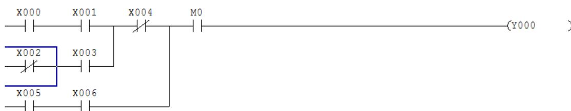
**Замечание** Звено должно иметь входную команду (подобную LD или LDI), и выходную команду (подобную OUT), чтобы завершить схему. Если выходная команда всегда должна быть включена, имеется специальный маркер с адресом M8000, перед которым помещается инструкция LD. Этот бит установлен, пока ПЛК находится в режиме RUN. Не разрешается подключать флаг выхода или команду в квадратных скобках непосредственно к левой вертикальной питающей шине релейной схемы.
