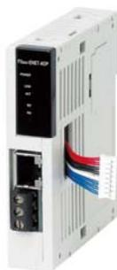
**FX2NC-ENET-ADP** можно подключить к ПЛК FX1S, FX1N, FX2N, и FX2NC. Для всех, кроме FX2NC потребуется FX\*N-CNV-BD. FX2NC-ENET-ADP – простой шлюз последовательный порт – Ethernet для ПЛК серии FX. GX Developer v8.25 и выше поддерживают Ethernet соединение с ПЛК серии FX через этот модуль. Для ранних версий программного обеспечения необходимы дополнительные драйверы.
