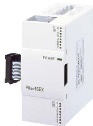
Блоки расширения без собственного блока питания включают 8 или 16 входов-выходов. Каждая клемма является либо входом, либо выходом, но не обоими. Входы работают от 24 В пост. тока, и имеются все три типа выходов. Если имеющиеся модели не удовлетворяют требованиям системы, можно использовать модули ПЛК серии FX0N, а также ПЛК серии FX2NC (с помощью конвертора FX2N-CNV-1F).
