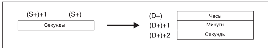
Рис. 7-155: Принцип действия команды DSTOH
