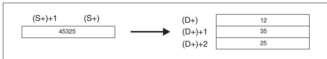
Рис. 7-156: Пример применения команды DSTOH: 45325 секунд соответствуют 12 часам, 35 минутам и 25 секундам.
