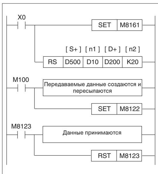
Рис. 7-31: Пример программирования RS-инструкции
