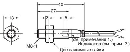
Примечание 1. Кабель круглого сечения, диаметр 4, с виниловой изоляцией, с 3-мя жилами (поперечное сечение жилы: 0,3 мм<sup>2</sup>; диаметр изоляции: 1,3 мм); стандартная длина: 2 м
