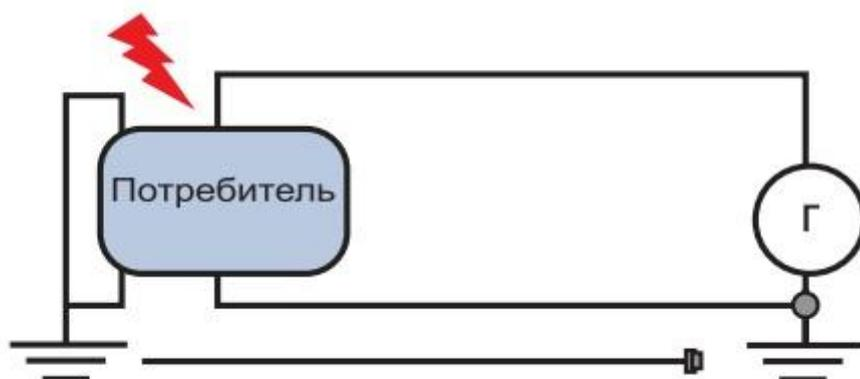
Рис. 3. Простейшая **схема заземления**
