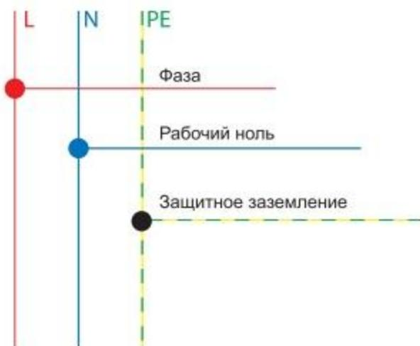
Рис. 1. Схема однофазной цепи
