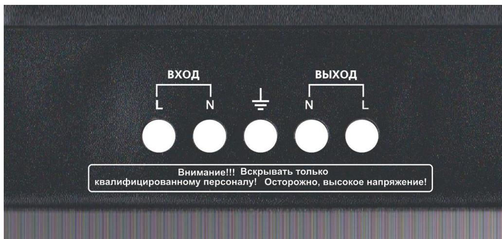
Рис.12 Подключение стабилизатора через клеммную колодку
