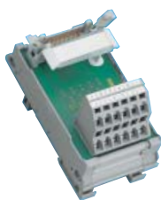
для контроллеров Siemens SIMATIC® с монтажным адаптером
