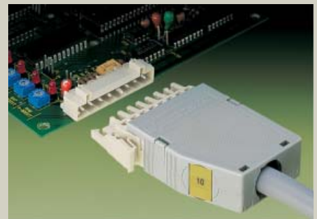
Розетка с фиксаторами в корпусе для крепления кабеля
