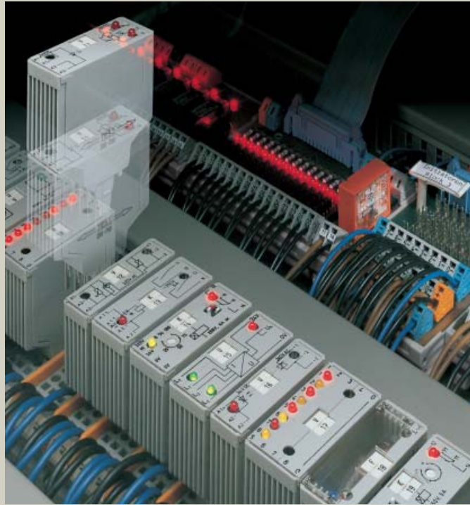
Установка модуля на несущую рейку
