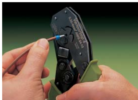
Вставить проводник с наконечником в обжимающую цангу.
