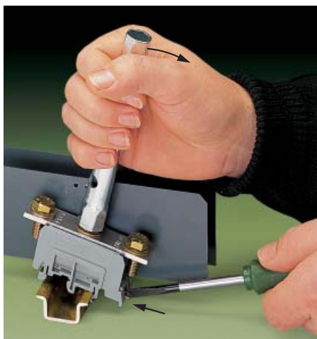
Демонтаж с DIN-рельса 35 мм
