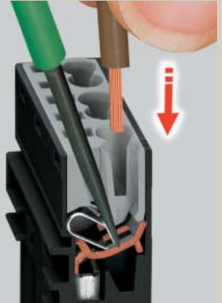
Подключение многожильных проводников: открыть зажим отверткой и вставить зачищенный провод до отказа
