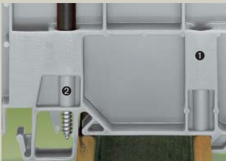
① Крепежный винт - предотвращает перемещение держателя по рельсу ② Удерживающий винт - предотвращает снятие держателя с рельса
