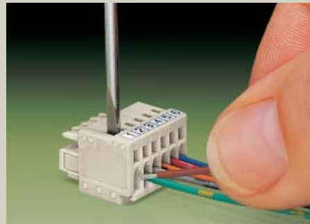
Подсоединение проводников – боковое подключение при помощи отвертки с лезвием (2.5 x 0.4) мм
