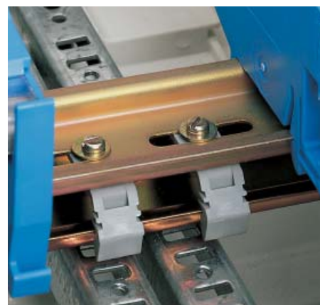
Изолированное крепление несущего рельса в распределительной коробке для обеспечения 2 класса защиты. Показано с клеммами типа topjob®.
