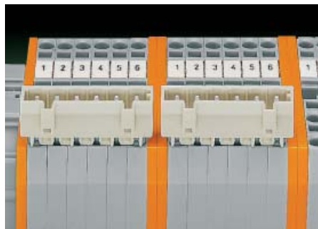
Соединители установлены в 2-уровневые клеммы серии 280 и промаркированы пластинами 280-360 и, 280-361.
