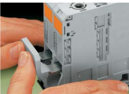
Объединение клемм перемычкой, устанавливаемой над отверстием для подключаемых проводников, допустимое сечение которых по-прежнему 95 мм 2
