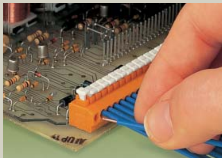
Подключение проводников с использованием нажимной кнопки
