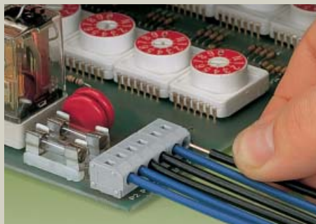
Подключение проводников без использования нажимной кнопки
