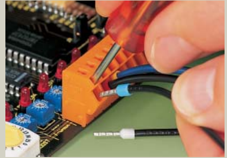
Подключение проводников - многожильный с обжимной трубчатой втулкой
