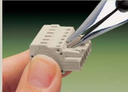
Кодировка розетки – выламывание кодировочных штифтов
