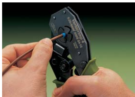
Сжать ручки до освобождения храпового механизма.
