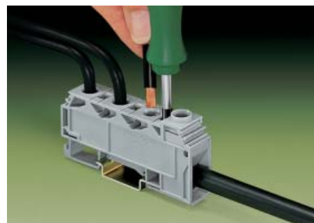
Проводники сечением до 10 мм 2 подключаются зажимом CAGE CLAMP, фронтальное подключение
