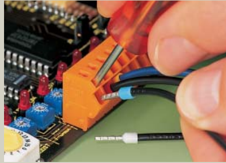
Отключение проводников - многожильный с обжимной трубчатой втулкой
