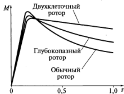
Рис. 11.16. Механические характеристики асинхронных короткозамкнутых двигателей с различными типами роторов
