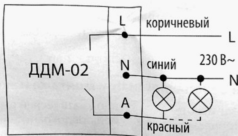
Рисунок 5. Схема подключения датчика движения ДДМ-02
