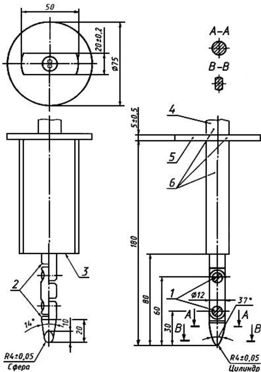
1 - шарниры; 2 - фаски; 3 - упорная поверхность; 4 - ручка; 5 - защитная шайба;
