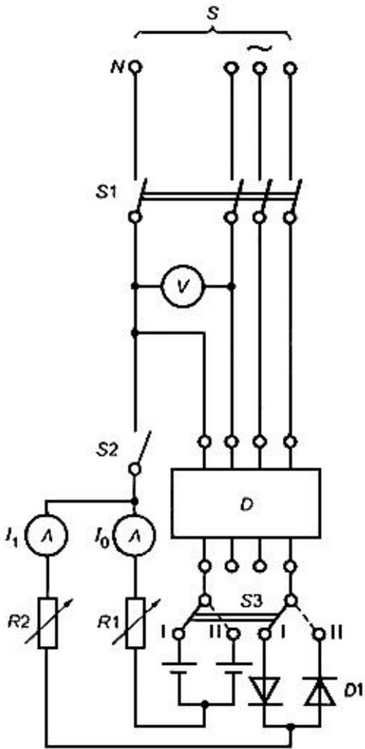
$S$  - источник питания;  $V$  - вольтметр;  $A$  - амперметр (измерение действующего значения);  $D$  - испытуемый ВДТ;  $D1$  - тиристоры;  $R1$ ,  $R2$  - регулируемые резисторы;  $S1$  - выключатель для всех полюсов;  $S2$  - однополюсный выключатель;  $S3$  - переключатель на два положения, два направления
