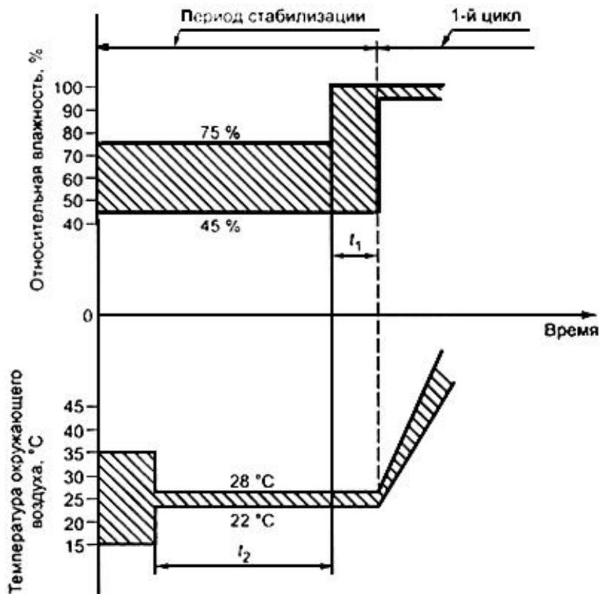
$t_1$  - время, требуемое для достижения 95-100% относительной влажности (не превышающее 1 ч);  $t_2$  - время, требуемое испытуемому образцу, чтобы достичь температурной стабильности
