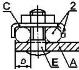
1 - необязательная часть (винтовые выводы); 2 - обязательная часть (штыревые выводы); A - неподвижная часть; B - шайба или прижимная пластина; C - устройство, препятствующее выскальзыванию жилы; D - канал для проводника; E - штырь
