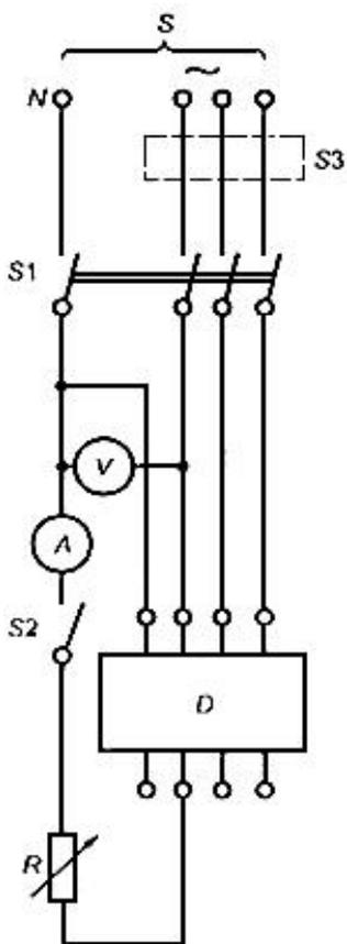
$S$  - источник питания;  $V$  - вольтметр;  $A$  - амперметр;  $S1$  - выключатель для всех полюсов;  $S2$  - однополюсный выключатель;  $S3$  - выключатель, коммутирующий все фазы, кроме одной;  $D$  - испытуемый АДТ;  $R$  - регулируемый резистор
