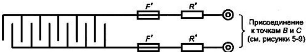
$F'$  - плавкий предохранитель;  $R'$  - резистор
