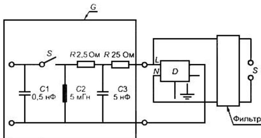
$G$  - генератор затухания колебаний волны;  $S_1$  - выключатель;  $D$  - ВДТ;  $S$  - источник питания;  $L$  - фазный проводник;  $N$  - нулевой рабочий проводник
