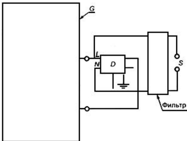
$G$  - генератор звонящей волны;  $D$  - ВДТ;  $S$  - источник питания
