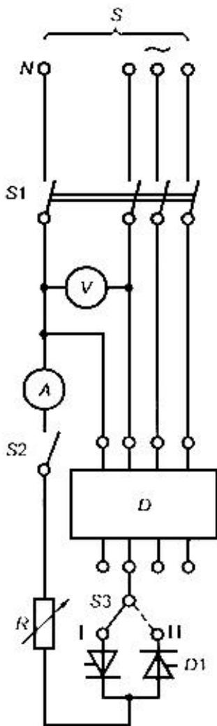
$S$  - источник питания;  $V$  - вольтметр;  $A$  - амперметр (измерение действующего значения);  $D$  - испытуемый ВДТ;  $D1$  - диоды;  $R$  - регулируемый резистор;  $S1$  - выключатель для всех полюсов;  $S2$  - однополюсный выключатель;  $S3$  - переключатель на два положения
