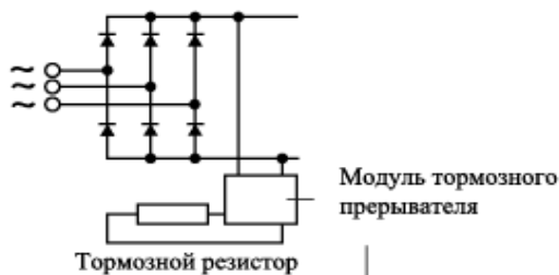
Рис. 3.19. Включение тормозного модуля и тормозного резистора
