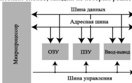
Рис. 2.40. Принципиальная схема микрокомпьютера
