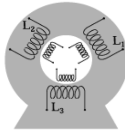
Рис. 1.14а Расположение обмоток статора и ротора
