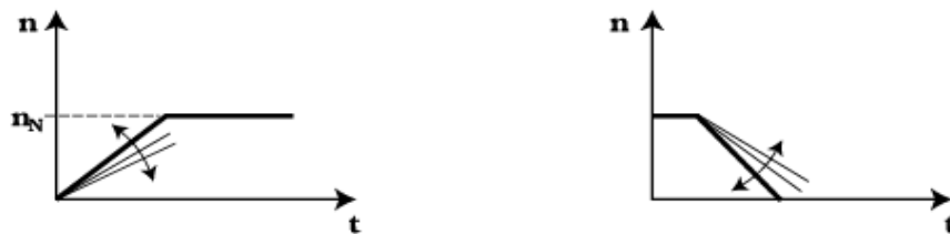
Рис. 3.23. Регулируемое время разгона и торможения
