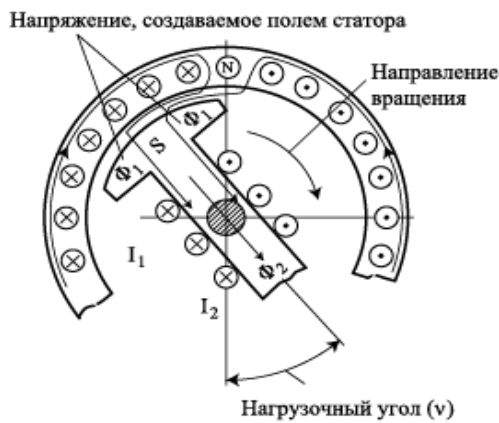
Рис. 1.37 Нагрузочный угол и рабочий крутящий момент в функции угла ротора
