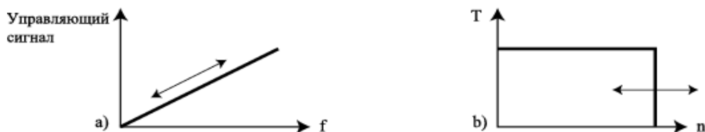
Рис. 3.16 Зависимость между управляющим сигналом и характеристиками крутящего момента электродвигателя
