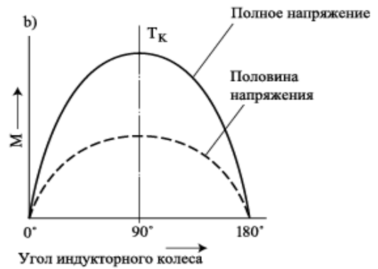
Рис. 1.37 Нагрузочный угол и рабочий крутящий момент в функции угла ротора
