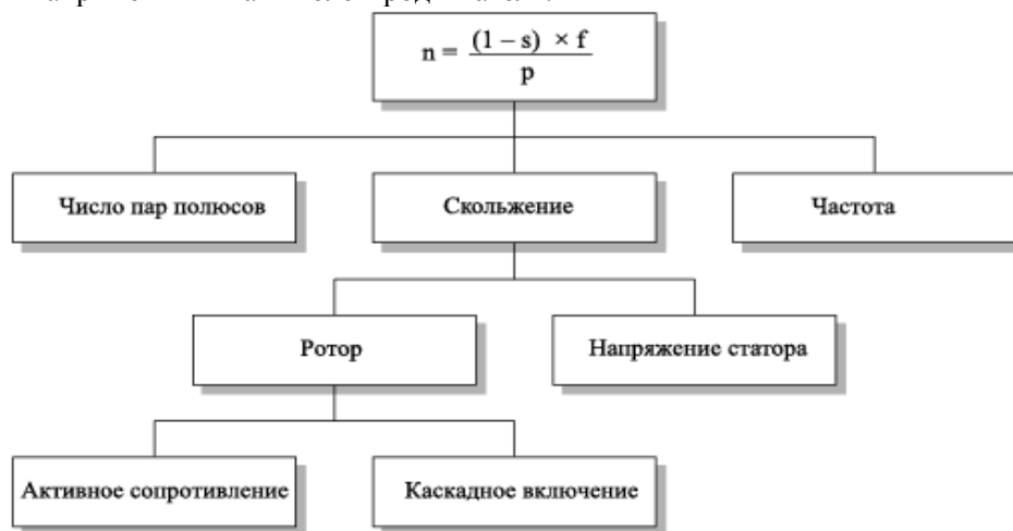
Рис. 1.17 Различные возможности изменения скорости электродвигателя
