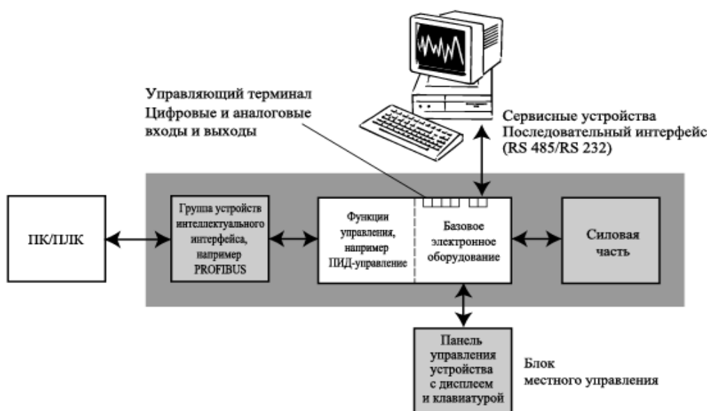
Рис. 2.43. Базовая комплектация средств связи (преобразователя частоты)
