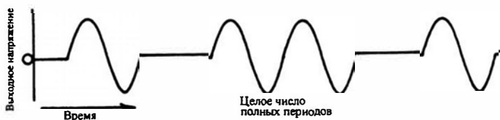
Рис. 10.5. Схема коммутатора, срабатывающего в момент пересечения напряжением нуля, для нагрузки, не требующей малого времени переходного процесса. Работа ограничена тем, что в нагрузку поступает один или несколько полных периодов синусоидального напряжения. Такой режим, характеризующийся наличием полных периодов переменного напряжения (известный как пакетная модуляция ), существенно уменьшает шум тиристорных коммутаторов. Этот метод регулирования хорош для работы с нагревателями, он обеспечивает плавное управление двигателями и продлевает срок жизни ламп накаливания.
