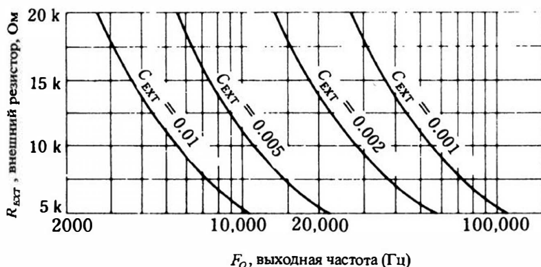
Рис. 3.10. Графики для определения частоты колебаний микросхемы MC3420.
