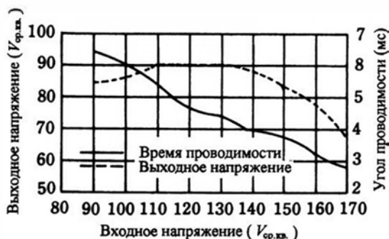
Рис. 5.39. Диапазон стабилизации напряжения сети у стабилизатора переменного напряжения, изображенного на рис. 5.38.
