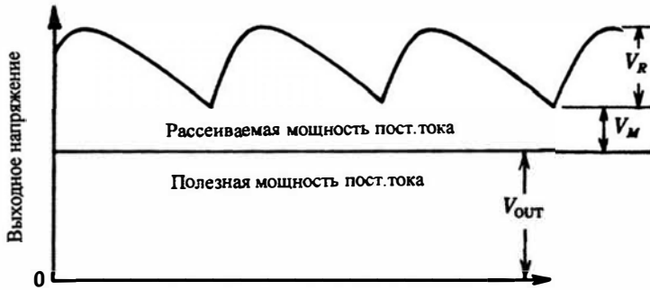
Рис. 10.2. Типичная ситуация рассеяния мощности в линейном стабилизаторе. Волнистая линия представляет собой нестабилизированное напряжение на выходе фильтра двухполупериодного выпрямителя. Только часть входной мощности будет передана в нагрузку в виде выходного напряжения линейного стабилизатора. Остальная часть мощности рассеивается в проходном стабилизирующем элементе линейного стабилизатора. Импульсный стабилизатор может использовать почти полную амплитуду входного напряжения.
