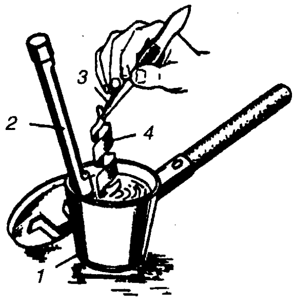
Рис. 7.12. Проверка бумажной изоляции кабеля на влажность:
