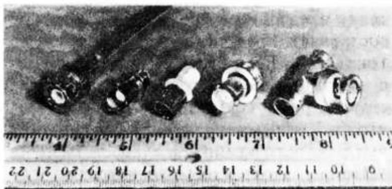
Рис. 1.102. Для экранированного (коаксиального) кабеля чаще всего используют разъемы типа BNC.
