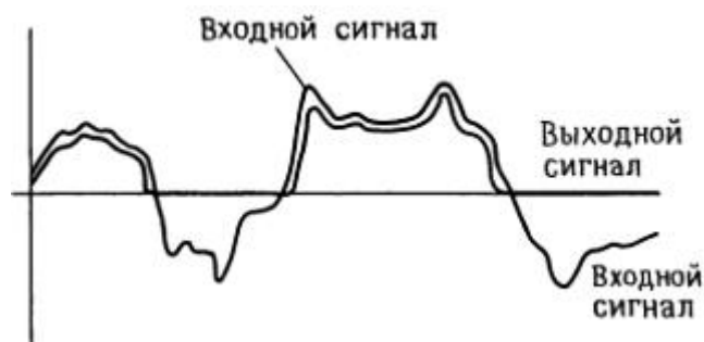
Рис. 2.15. Транзисторный усилитель с положительным источником питания не может генерировать на выходе импульсы отрицательной полярности.
