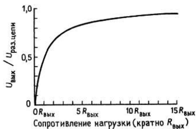
Рис. 1.12. Сопротивление нагрузки должно быть большим по сравнению с выходным сопротивлением для того, чтобы сигнал источника не ослаблялся ниже значения напряжения при разомкнутой цепи.
