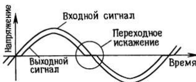
Рис. 2.56. Переходные искажения в двухтактном повторителе.
