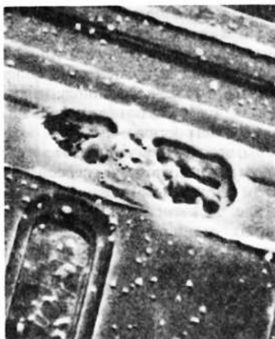
Рис. 3.76. Сканирующая электронная микрофотография высокого разрешения ( \times 1200 ) 6-амперного МОП-транзистора, разрушенного зарядом в 1 кВ, от «эквивалента человеческого тела» (1,5 кОм, включенного последовательно с емкостью 100 пФ), приложенного к его затвору.
