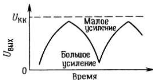
Рис. 2.36. Нелинейный выходной сигнал, снимаемый с усилителя с заземленным эмиттером.
