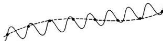
Рис. 11.16. Возникновение побочной низкочастотной составляющей в результате субдискретизации.
