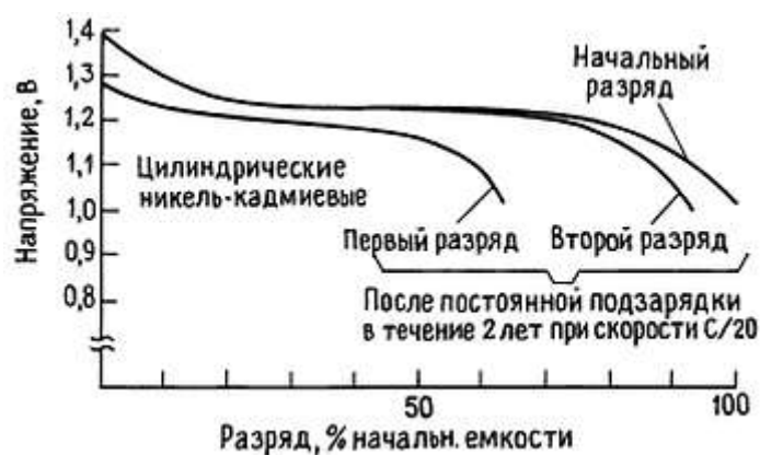
Рис. 14.5. «Глубокий разряд» восстанавливает «хорошее здоровье» никель-кадмиевой батареи.
