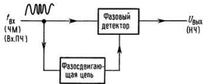
Рис. 9.78. Квадратурное ЧМ-детектирование.
