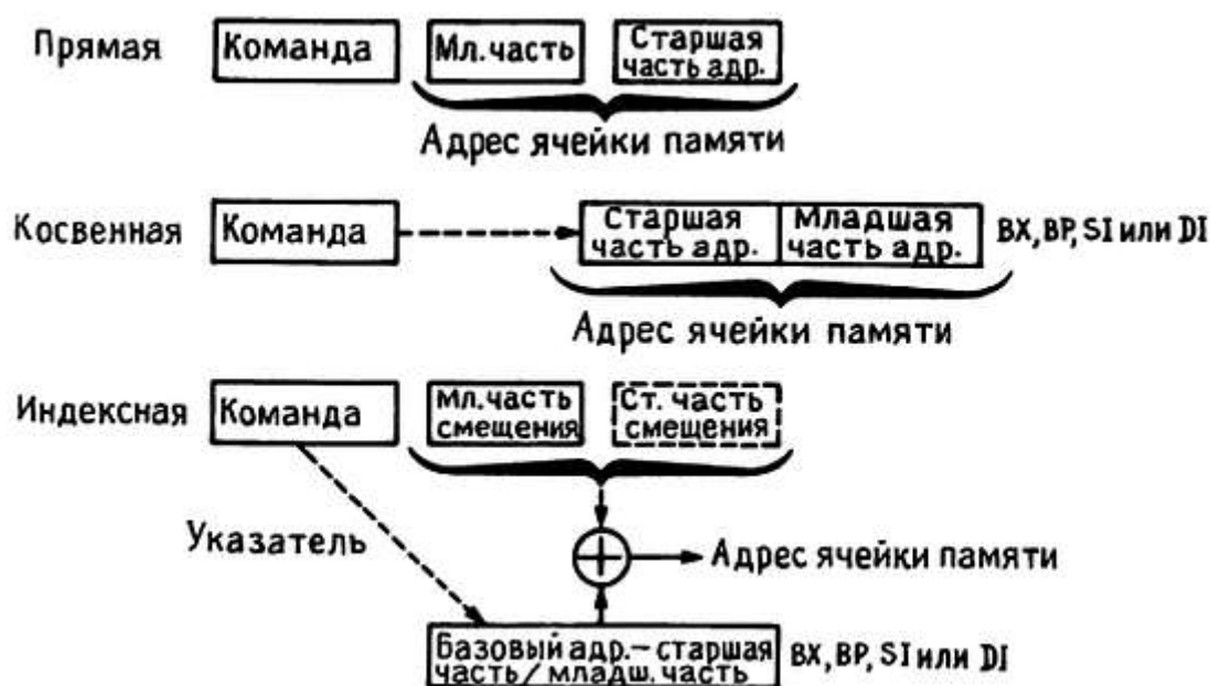
Рис. 10.3. Некоторые способы адресации.
