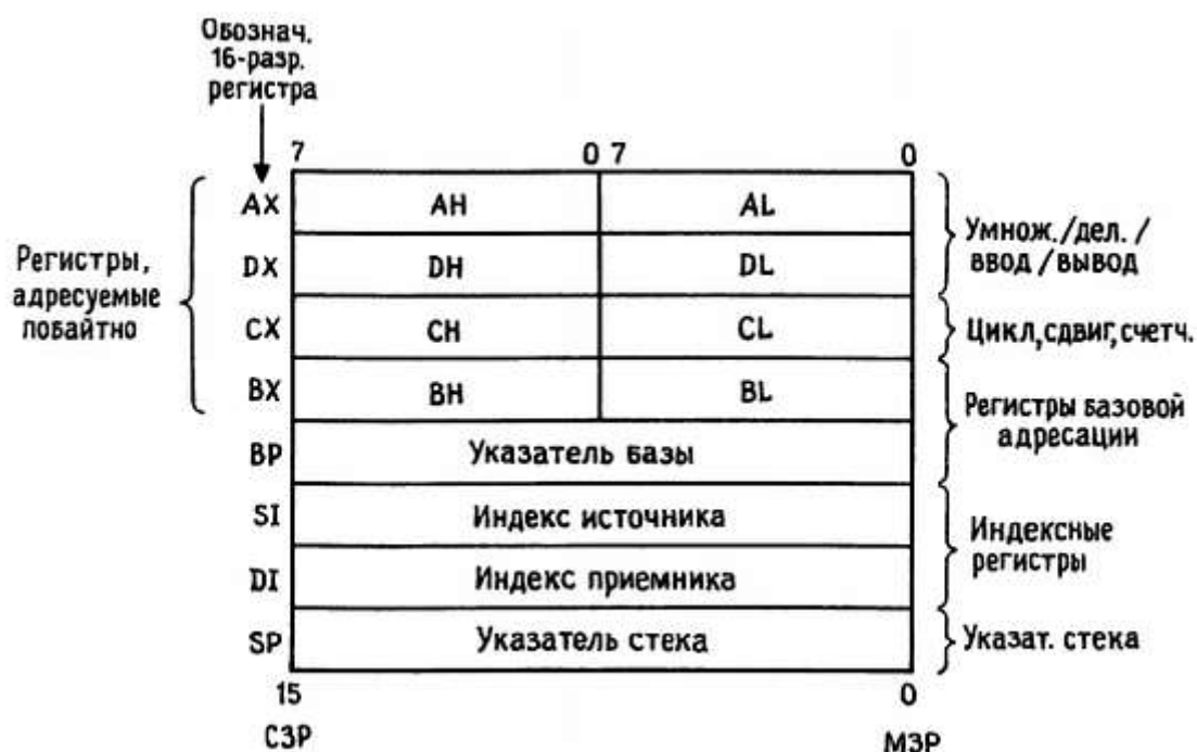
Рис. 10.2. Регистры общего назначения МП 8086.
