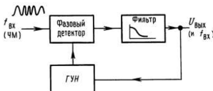
Рис. 9.77. ЧМ-дискриминатор с ФАПЧ.
