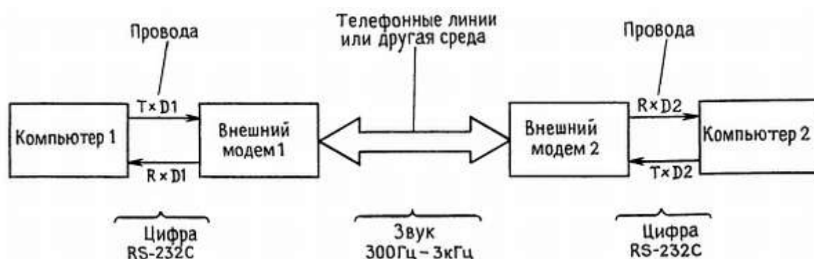
Рис. 10.18. Связь через модем.
