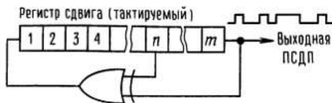
Рис. 9.82. Генератор псевдослучайной двоичной последовательности.
