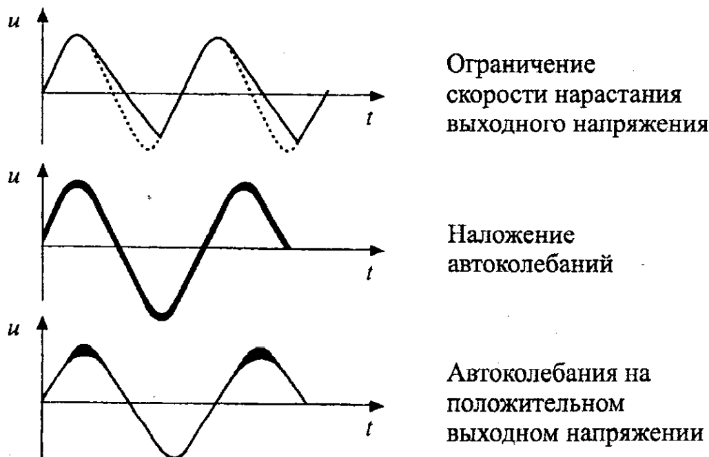
Рис. 5.32. Выходные сигналы неисправного операционного усилителя
