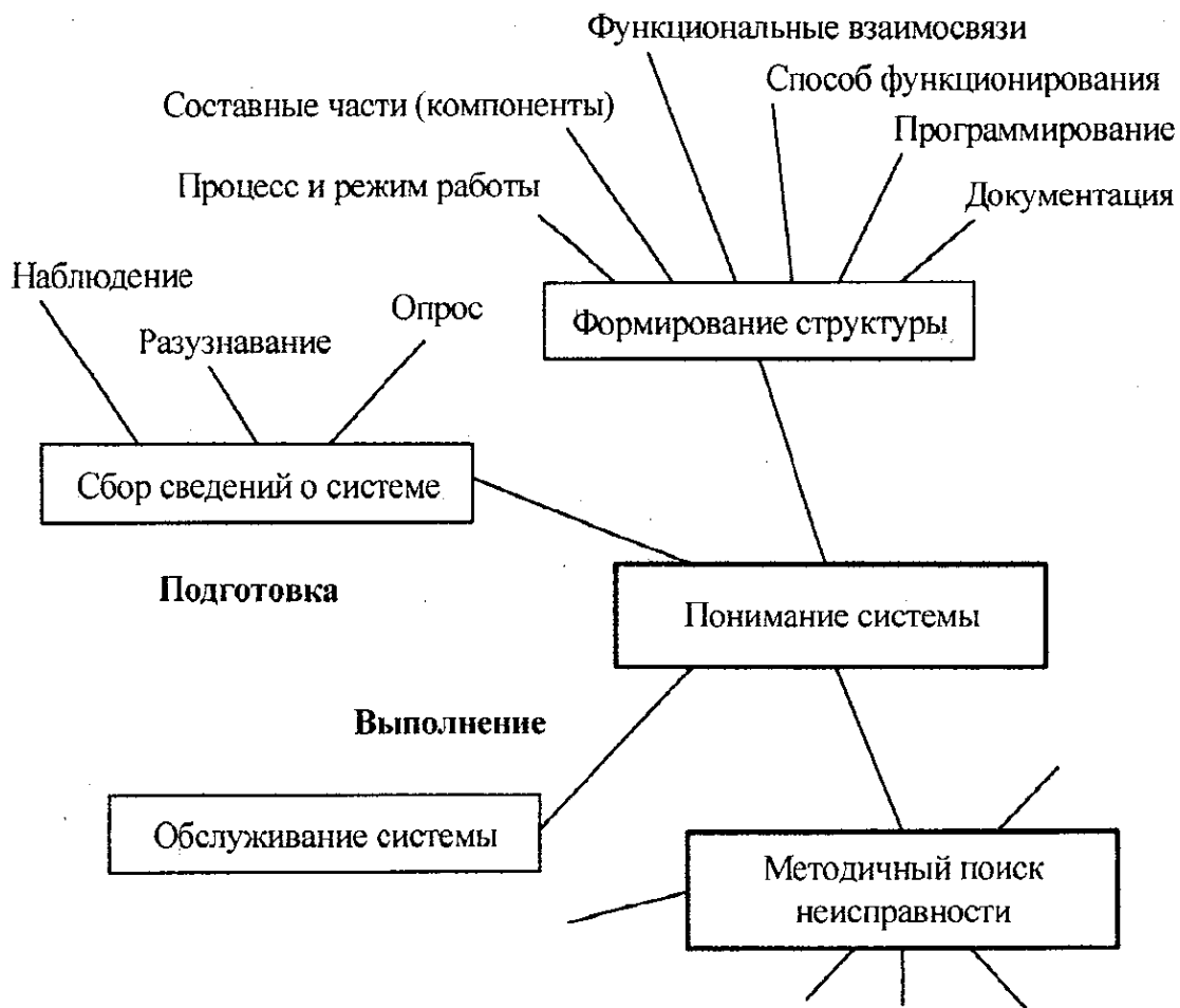
Рис. 3.1. Структурная схема поиска неисправности
