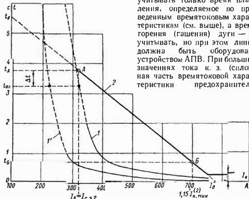
Рис. 1-18. Схема сети (а) и карта селективности (б) к примеру 1-3 выбора уставок новой защиты типа ТЗВР (2)
