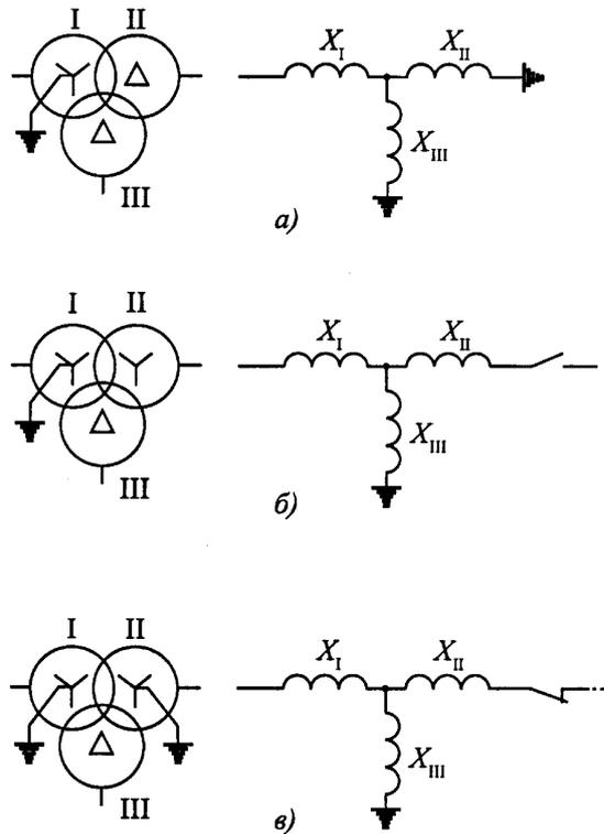
Рис. 3.2. Схемы замещения нулевой последовательности трехобмоточных трансформаторов
