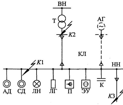
Рис. 6.7. Типовая расчетная схема узла комплексной нагрузки
