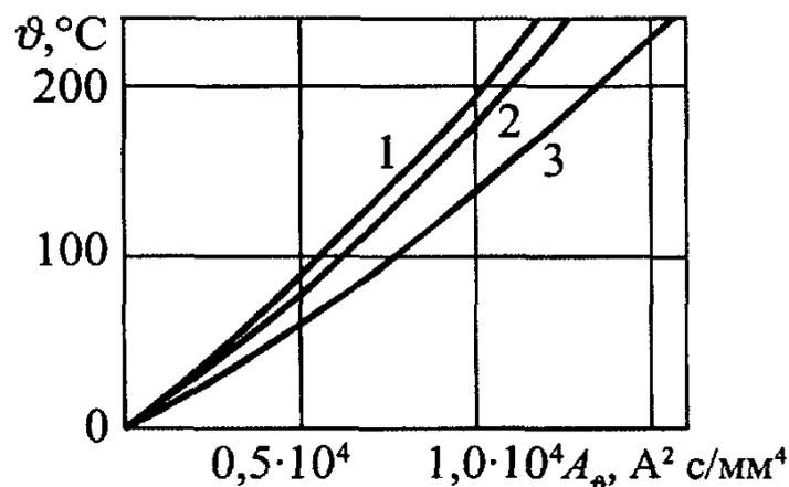
Рис. 8.9. Кривые для определения температуры нагрева проводов при коротких замыканиях
