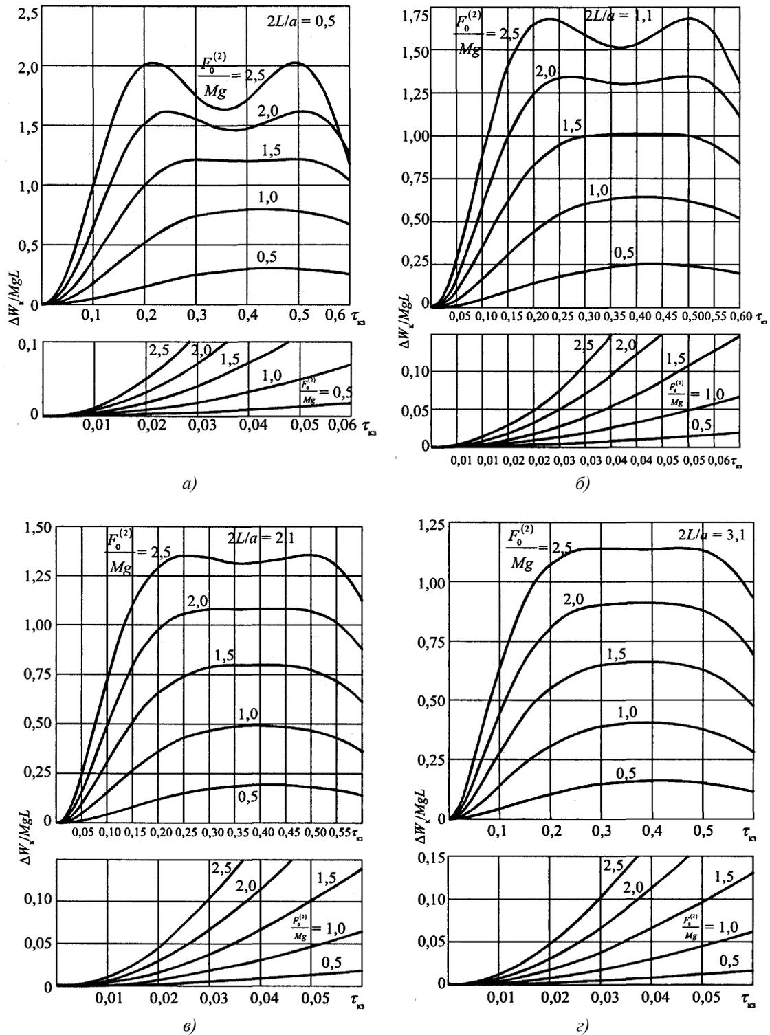
Рис. 7.11. Характеристики  $\Delta W_k / MgL$  при двухфазном КЗ
