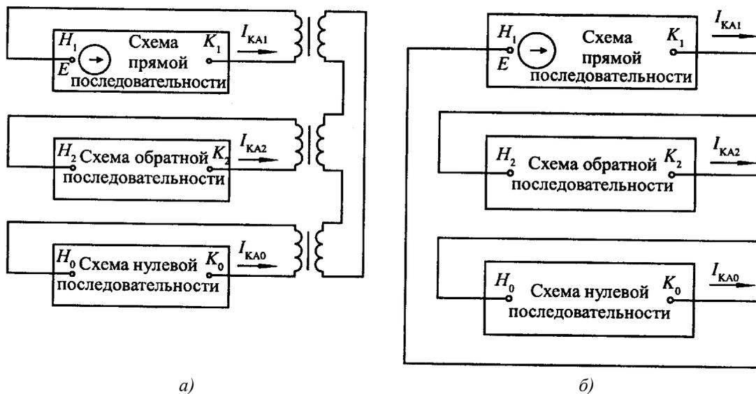
Рис. 3.5. Комплексные схемы замещения для однофазного КЗ:
