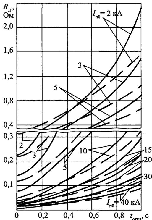
**Рис. 5.18.** Зависимость  $R_d = f(t_{\text{откл}}, I_{\text{п0}})$  при КЗ в электроустановках с кабельными линиями напряжением 6 кВ (сплошные кривые) и 10 кВ (пунктирные кривые)
