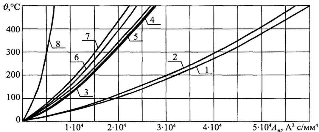
Рис. 8.8. Кривые для определения температуры нагрева проводников из различных материалов при коротких замыканиях
