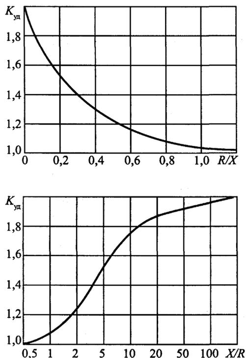
Рис. 6.1. Кривые зависимости ударного коэффициента  $K_{уд}$  от отношений  $R/X$  и  $X/R$
