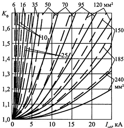
**Рис. 6.8.** Зависимости коэффициента увеличения активного сопротивления кабелей различных сечений с алюминиевыми жилами от тока дугового устойчивого КЗ с учетом теплоотдачи при продолжительностях КЗ 0,2 с (сплошные кривые) и 0,6 с (пунктирные кривые)
