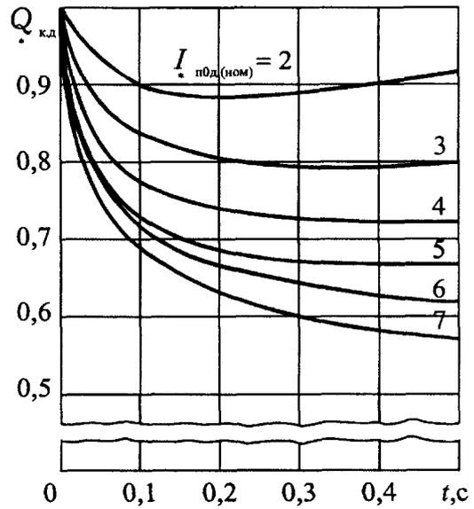
Рис. 8.5. Кривые для определения  $Q_{* \text{к.д.}}$  от синхронного электродвигателя
