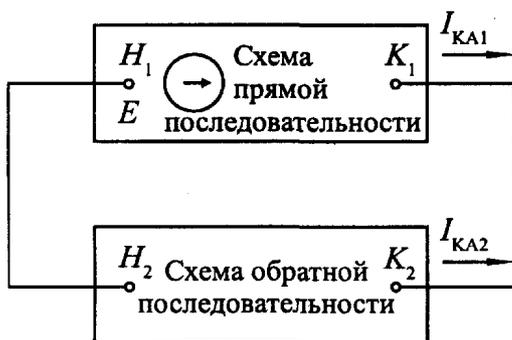
Рис. 3.3. Комплексная схема замещения для двухфазного КЗ
