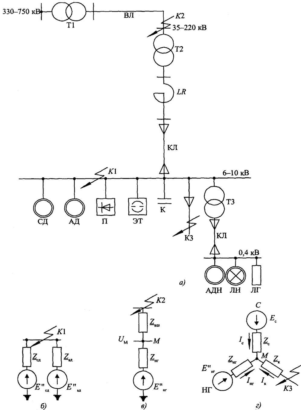
Рис. 5.14. Схема узла комплексной нагрузки и ее преобразование
