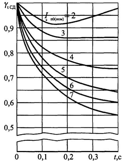
Рис. 6.4. Типовые кривые для синхронного электродвигателя напряжением до 1 кВ
