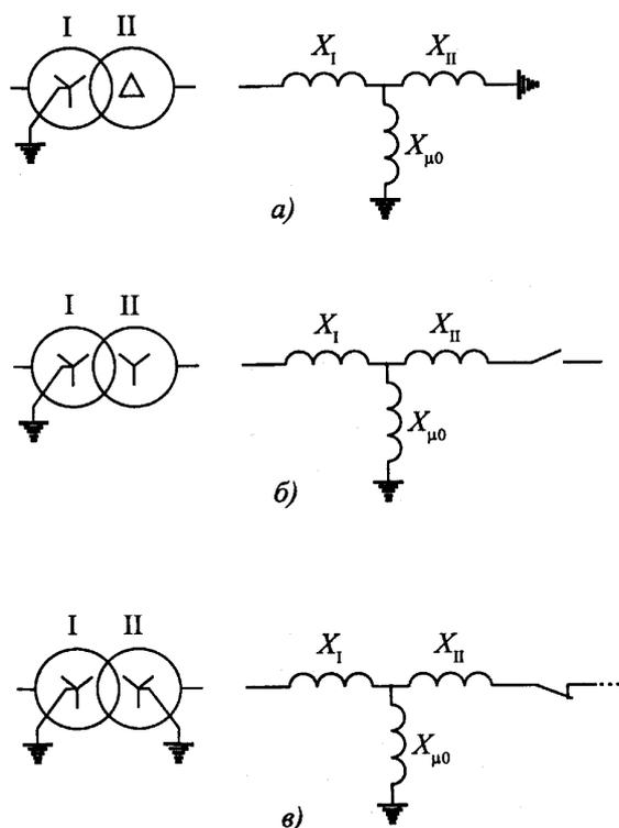
**Рис. 3.1.** Схемы замещения нулевой последовательности двухобмоточных трансформаторов
