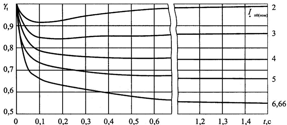
**Рис. 5.7.** Типовые кривые изменения периодической составляющей тока КЗ от синхронного генератора напряжением 6-10 кВ автономной системы электроснабжения
