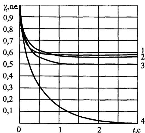
**Рис. 5.5.** Типовые кривые изменения периодической составляющей тока КЗ от турбогенераторов с различными системами возбуждения при трехфазных КЗ на выводах генераторов
