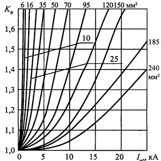
**Рис. 6.9.** Зависимости коэффициента увеличения активного сопротивления кабелей различных сечений с алюминиевыми жилами от тока дугового устойчивого КЗ с учетом теплоотдачи при продолжительностях КЗ 1-1,5 с
