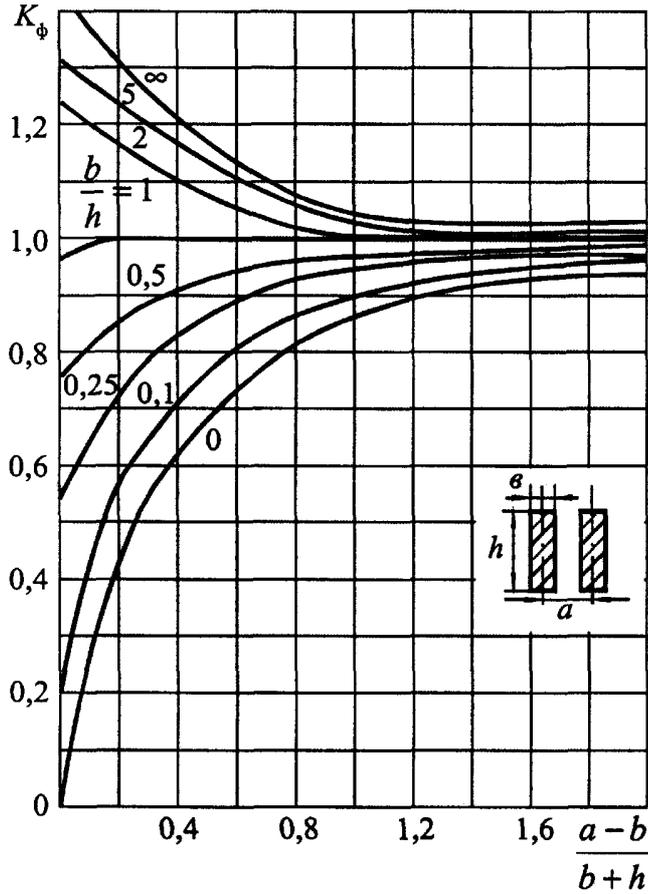
Рис. 7.3. Диаграмма для определения коэффициента формы шин прямоугольного сечения
