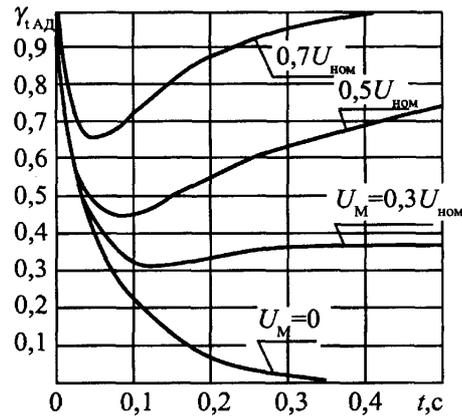
Рис. 5.16. Расчетные кривые для асинхронного электродвигателя
