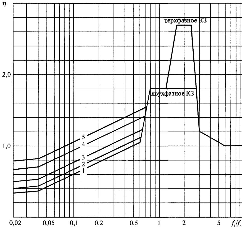
**Рис. 7.5.** Зависимость динамического коэффициента для изоляторов и шин от частоты собственных колебаний шины, где 1 при  $K_{\text{уд}} \geq 1,60$ ; 2 при  $K_{\text{уд}} = 1,40$ ; 3 при  $K_{\text{уд}} = 1,25$ ; 4 при  $K_{\text{уд}} = 1,10$ ; 5 при  $K_{\text{уд}} = 1,00$
