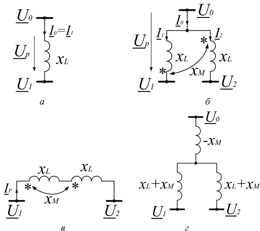
Рис. 1.17. Схемы замещения двоянного реактора
