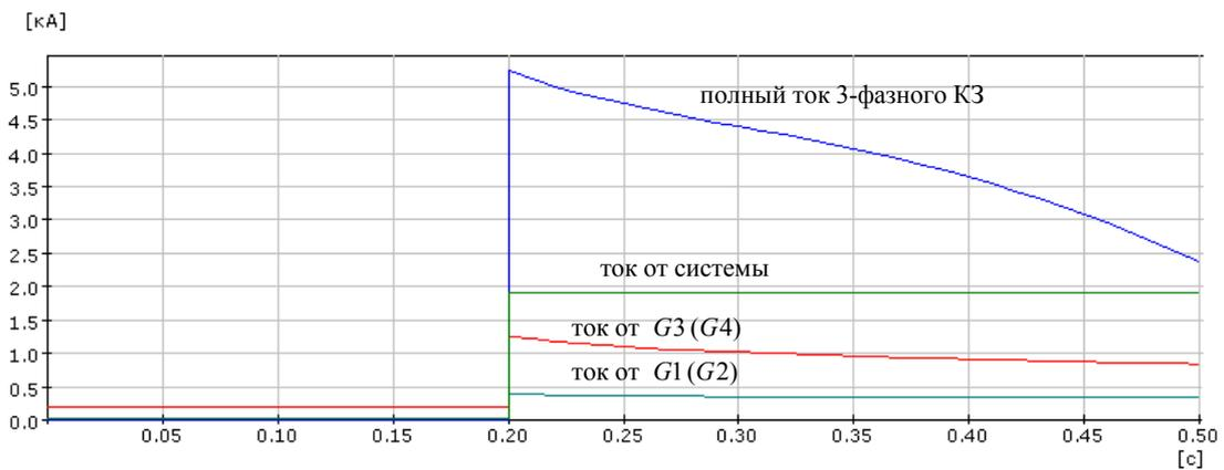
Рис. П2.5. Трехфазное КЗ на шинах 220 кВ
