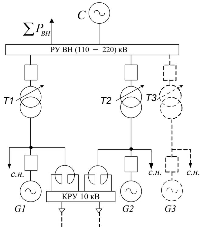
Рис. 2.5. Принципиальная схема ТЭЦ блочного типа
