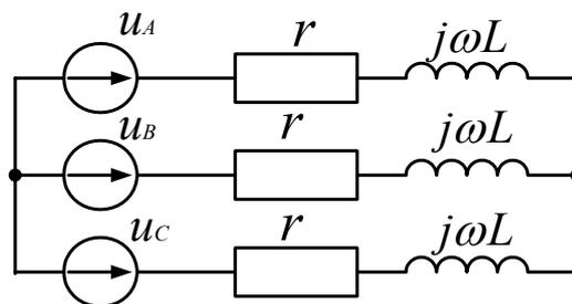
Рис. 1.8. Расчетная схема замещения трехфазной симметричной цепи
