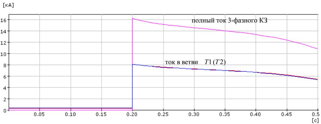
Рис. П2.4. Трехфазное КЗ на шинах 35 кВ
