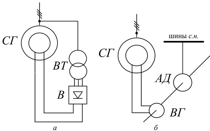
Рис. 1.4. Принципиальные схемы зависимой системы возбуждения генераторов;
