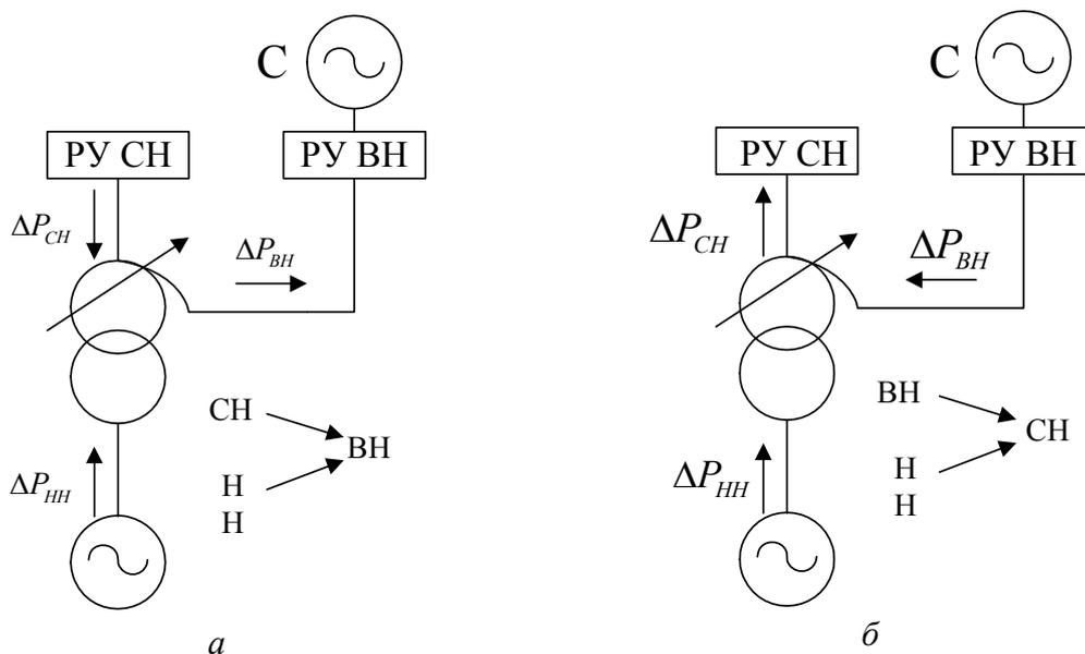
Рис. 2.12. Работа автотрансформатора в комбинированных режимах
