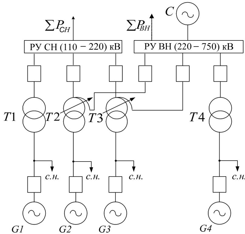
Рис. 2.6. Принципиальная схема КЭС с двумя автотрансформаторными блоками
