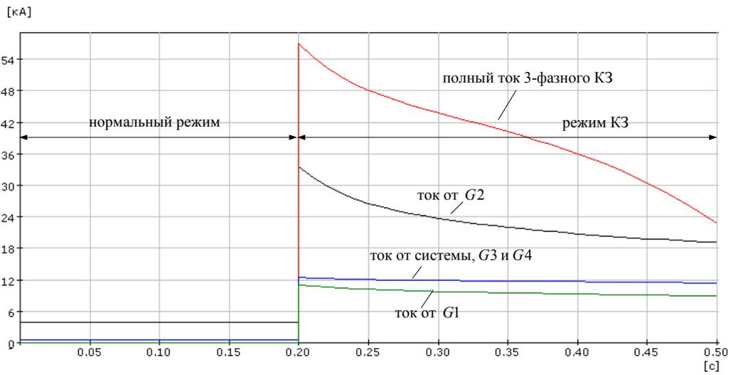
Рис. П2.3. Трехфазное КЗ на секции 2 ГРУ
