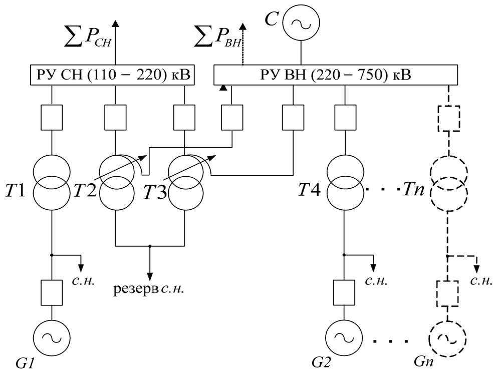
Рис. 2.7. Принципиальная схема КЭС с двумя автотрансформаторами связи
