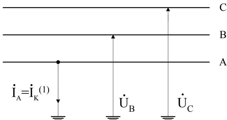
Рис. 1.20. Однофазное короткое замыкание в трехфазной сети
