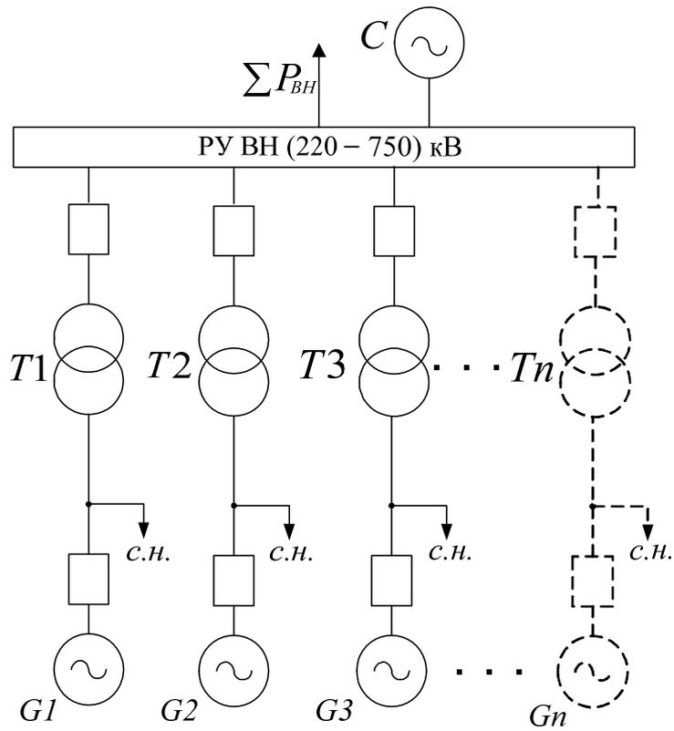
Рис. 2.8. Принципиальная схема КЭС с одним РУ ВН
