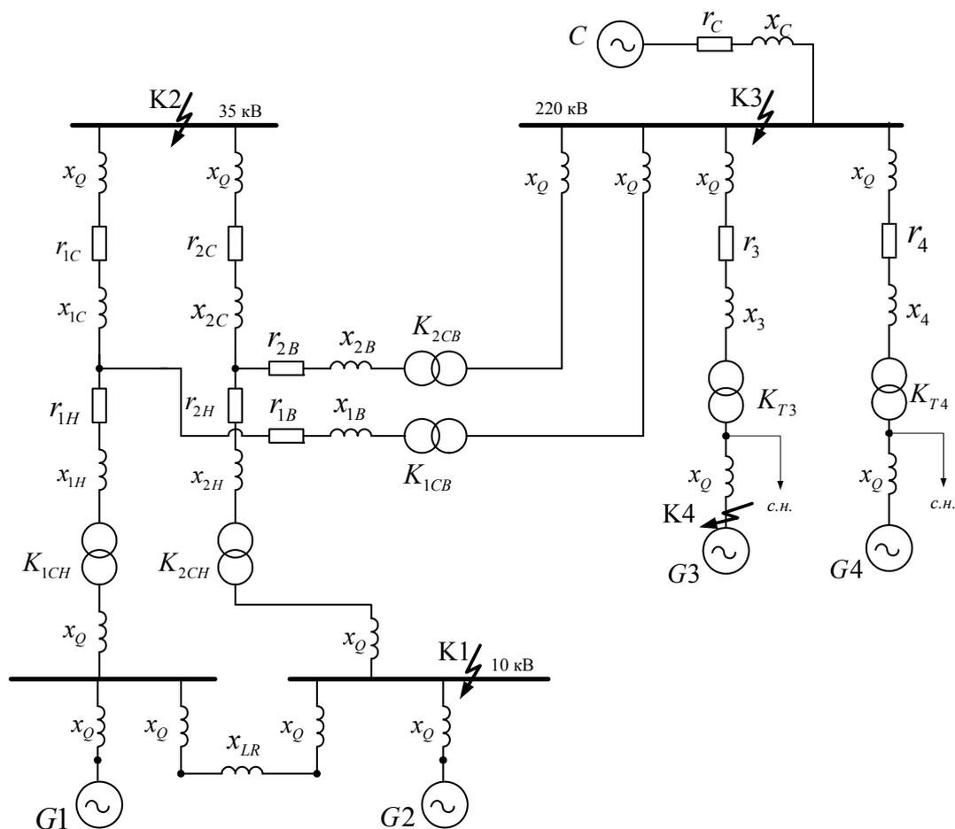
Рис. П2.2. Схема замещения ТЭЦ
