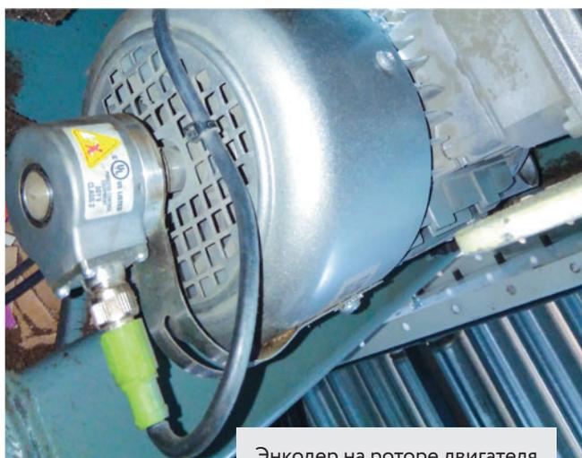
Энкодер на роторе двигателя
