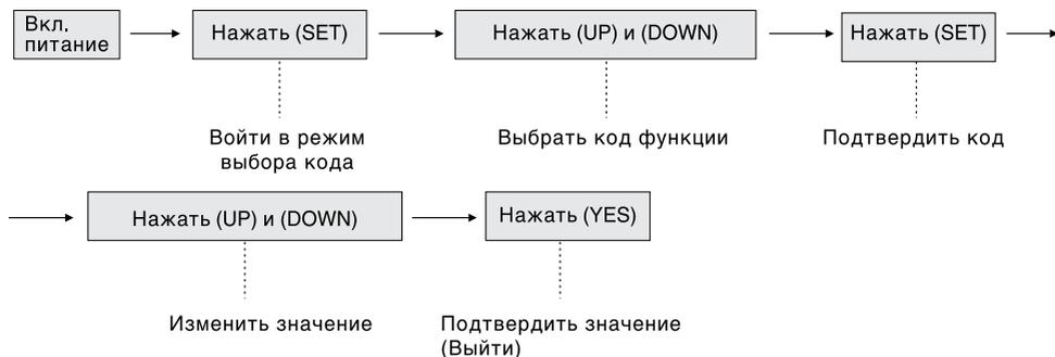
Пример настройки (Режим управления, управление с внешнего терминала, FD равно 2).
