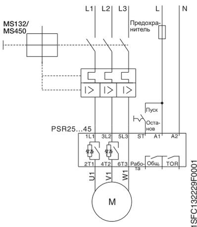
Е) С автоматом защиты электродвигателя и дополнительным контактом
