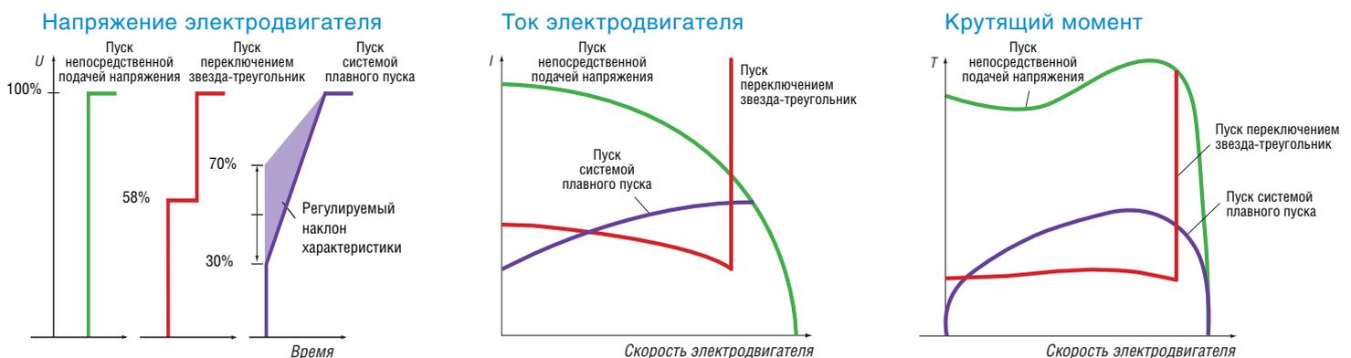
На графиках показаны основные отличия между пуском непосредственной подачей напряжения (DOL), пуском переключением звезда-треугольник и пуском системой плавного пуска в отношении напряжения на электродвигателе (U), тока электродвигателя (I) и его крутящего момента (T).
