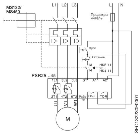
Ф) С предохранителями, контактором и защитой от перегрузки
