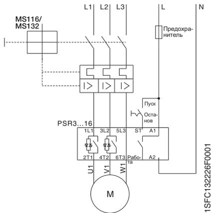
В) С автоматом защиты электродвигателя и дополнительным контактом
