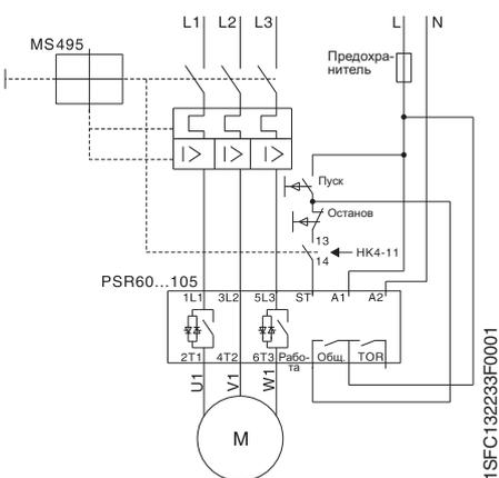
И) С предохранителями, контактором и защитой от перегрузки
