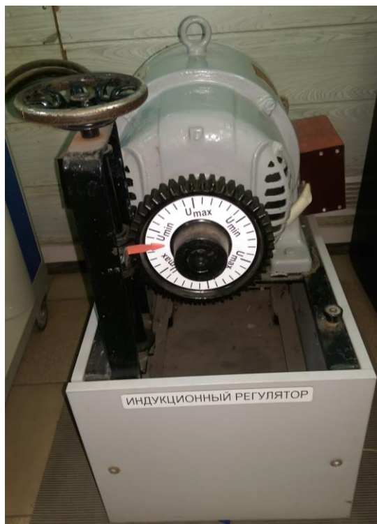
Рисунок 14.7. – Фотографии приборной панели лабораторного стенда – (a) и трехфазной асинхронной машины с неподвижным ротором – (б): p = 3
