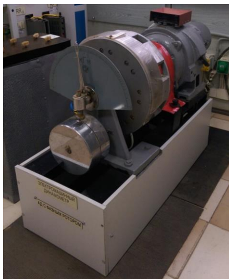
Рисунок 11.7. – Фотография исследуемого агрегата «Трехфазный асинхронный двигатель с фазным ротором – электромашинный динамометр» (номинальные данные – см. рис. 11.3)
