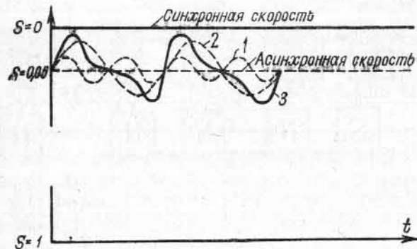
Рис. 13-11. Зависимость скольжения синхронного двигателя от времени пуска при асинхронном пуске с втягиванием в синхронизм
