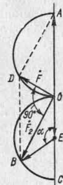
Рис. 29-27. Диаграмма н. с. трехфазного коллекторного двигателя последовательного возбуждения с двойной системой щеток
