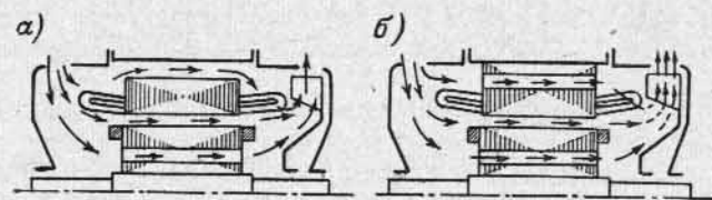
Рис. 6-6. Простая и двойная осевая вентиляция
