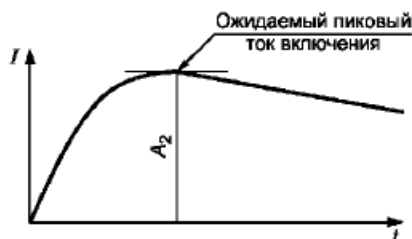
Рисунок 7b - Калибровка испытательной цепи для постоянного тока
