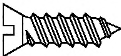
Рисунок 1 — Самонарезающий формирующий винт (см. 3.3.22)
