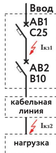
До сих пор мы говорили о токе КЗ в конце кабельной линии, в районе нагрузки. Этот ток обозначен как  $I_{кз2}$ . Но в электрощите, где установлены оба автоматических выключателя, ток КЗ, обозначенный как  $I_{кз1}$ , может быть ощутимо выше. В нашем случае в щитке он может быть более 200 А. И если замыкание происходит в щитке после вводного АВ (а это бывает в основном из-за человеческого фактора), он мгновенно выключится.
