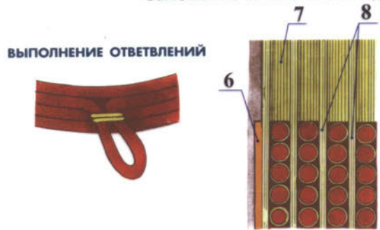
ИЗОЛЯЦИЯ В ТОРЦЕВОЙ ЧАСТИ МНОГОСЛОЙНОЙ ЦИЛИНДРИЧЕСКОЙ ОБМОТКИ ИЗ КРУГЛОГО ПРОВОДА
