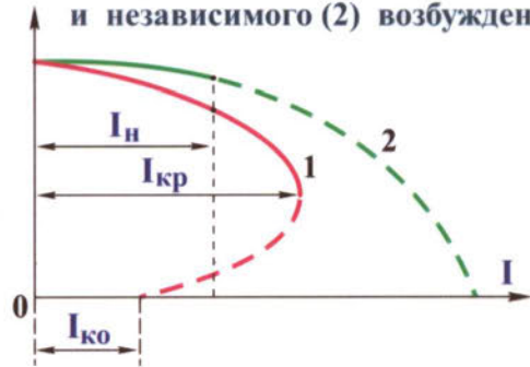
Приближенное построение внешней характеристики генератора параллельного возбуждения
