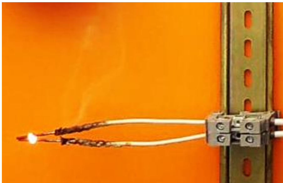
Рис. 5. Пиролиз ПВХ изоляции из-за нагрева соединения при касании проводников сечением 2,5 \text{ мм}^2 , ток 25 \text{ А} .
