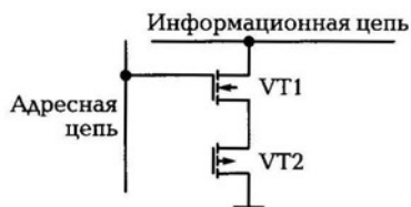
Рис. 6.3. Элемент памяти с электрической записью информации
