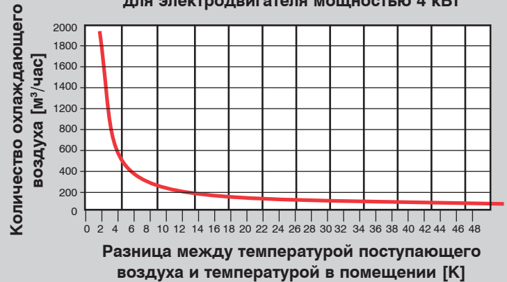
Необходимый приток воздуха для электродвигателя мощностью 4 кВт
