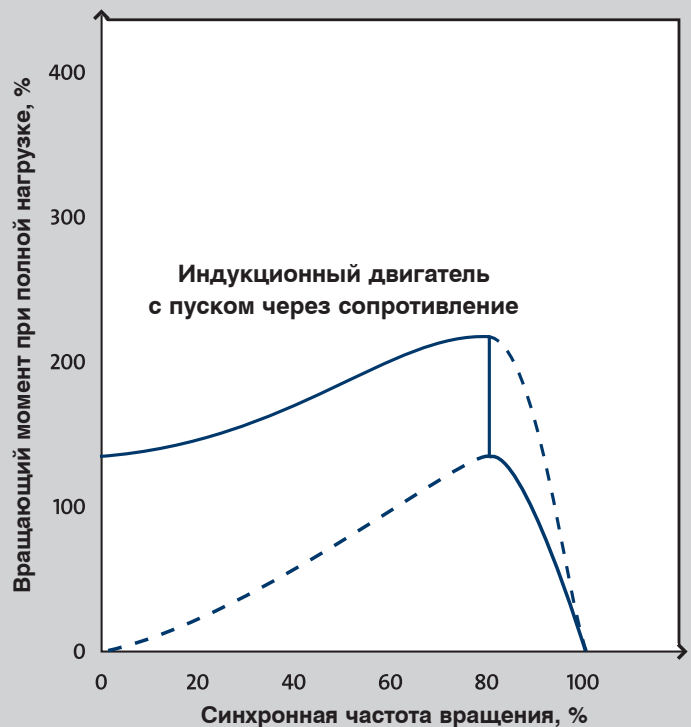
Электродвигатель RSIR. Схема электрических соединений и характеристика пусковой момент/частота вращения
