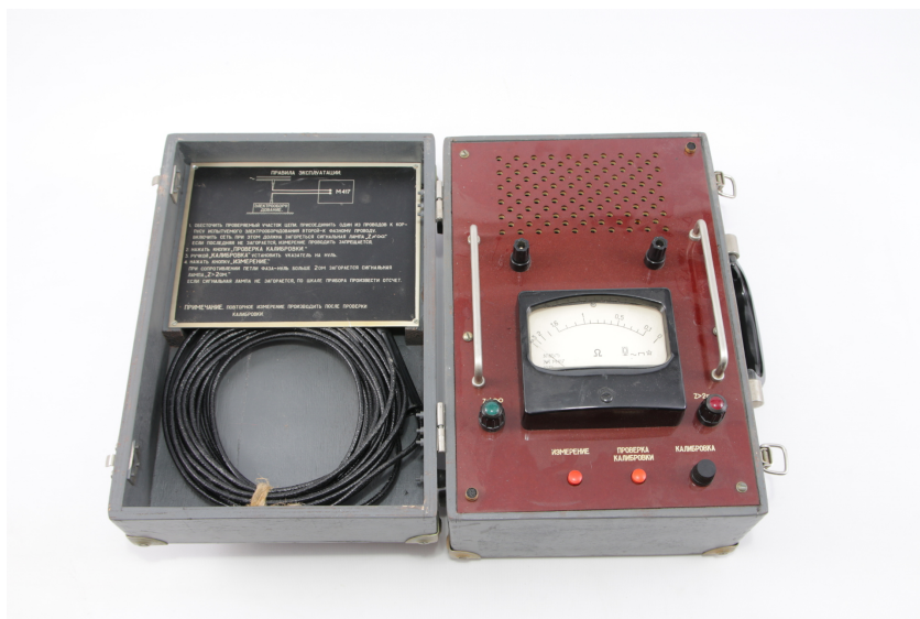
Рисунок 29 Измеритель сопротивления петли фаза-ноль М417. Производства СССР
