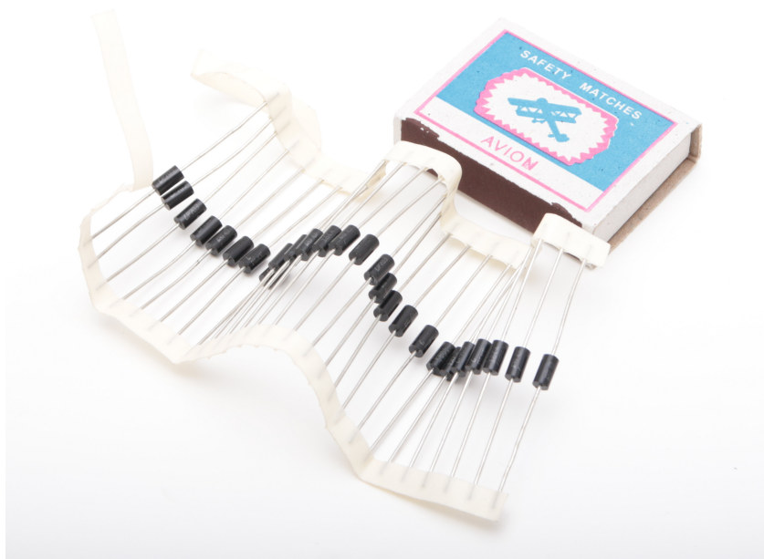
Рисунок 98 Полупроводниковые супрессоры P6KE18CA двунаправленные, напряжение ограничения 25 Вольт. (Классификационное напряжение 18 Вольт, при нём ток утечки составит 1 мА). Способен рассеивать 600 Вт, но только в импульсе 10/1000.
