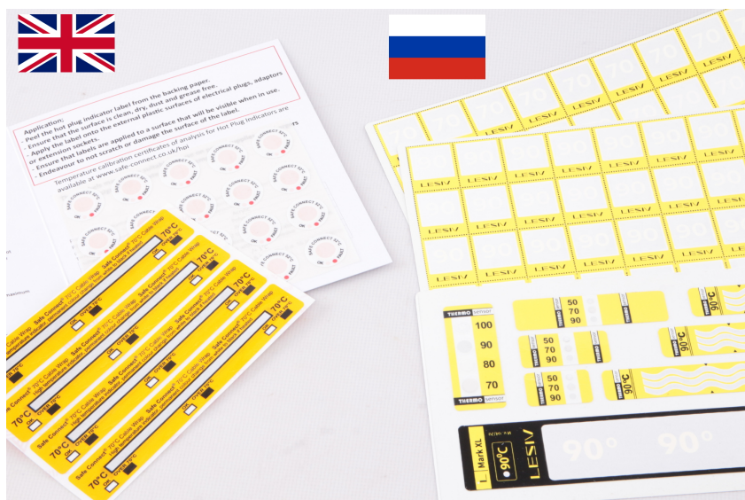
Рисунок 63 Наклейки – термоиндикаторы отечественного и британского производства. Температура срабатывания круглых британских наклеек 52°C, полосковых британских 70°C. У отечественных – точки с температурами срабатывания 50°C, 70°C, 80°C, 90°C, 100°C, квадратные на 70°C и 90°C, полосковые на 90°C. Набор возможных температур индикаторов плавления весьма широк, я встречал варианты наклеек от 20°C до 290°C
