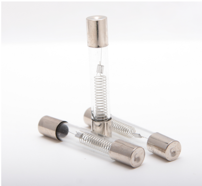
Рисунок 5 Высоковольтные предохранители от микроволновых печей, 750 мА 5 кВ
