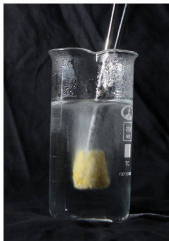
Рисунок 71 Выделение газа из материала наклейки при погружении в горячую воду с температурой выше температуры активации.
