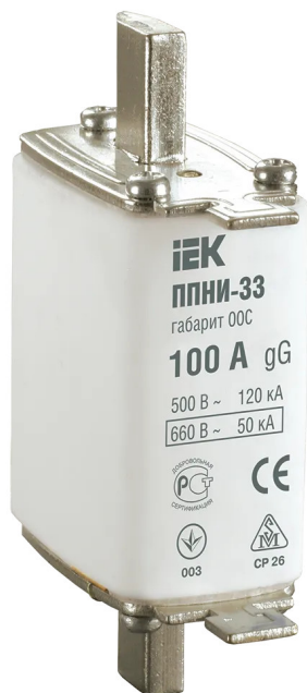
Рисунок 6 Брутальный предохранитель ПНИ-33 от компании IEK. При номинальном токе 100А способен отключать ток до 120000 А при 500 В и до 50000 А при 660 В
