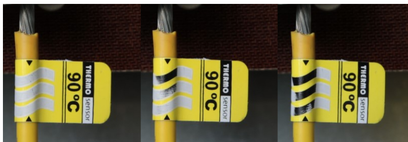
Рисунок 65 Процесс изменения цвета наклейки при нагреве от компании "Термо-электрика".
