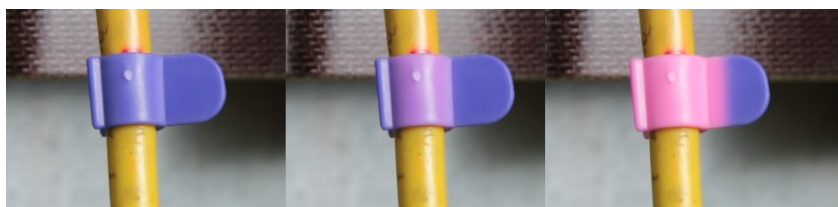
Рисунок 68 Процесс изменения цвета термоиндикаторной клипсы от компании Safe Connect.
