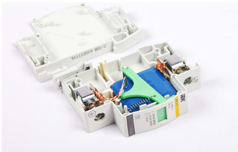
Рисунок 96 Внутренности ограничителя перенапряжений ОПС-1 от компании IEK.
