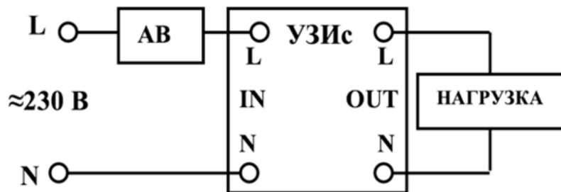
Рис. 3.1. Подключение УЗИс с автоматическим выключателем (АВ)
