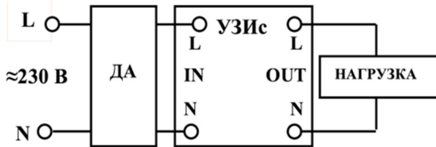
Рис. 3.2. Подключение УЗИС с дифференциальным автоматом (ДА)
