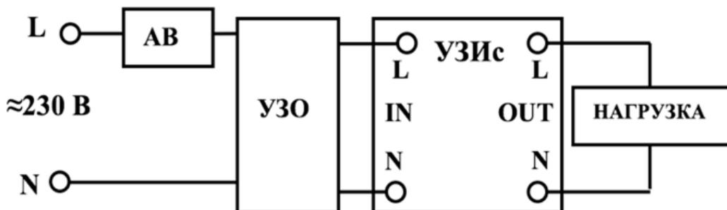
Рис. 3.3. Подключение УЗИС с автоматическим выключателем (АВ) и устройством защитного отключения (УЗО)
