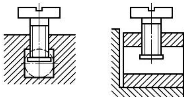
**Выводы с прижимными пластинами**
