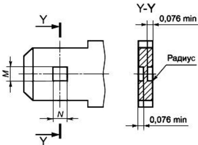
Допуск расположения углублений относительно центральных осей штекера  $0,13 \text{ мм}$ .
