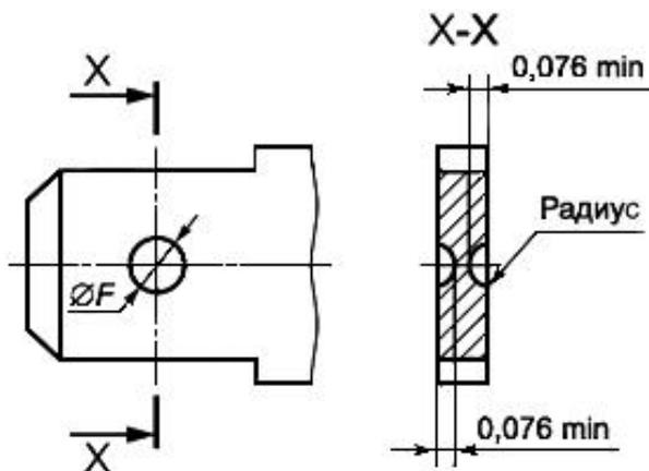
Допуск расположения углублений относительно центральных осей штекера  $0,076 \text{ мм}$ .
