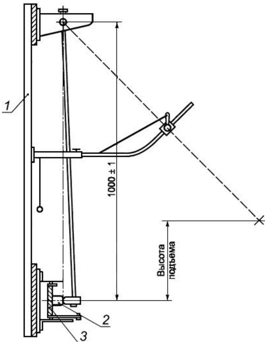
1 - опора; 2 - образец; 3 - монтажная опора
