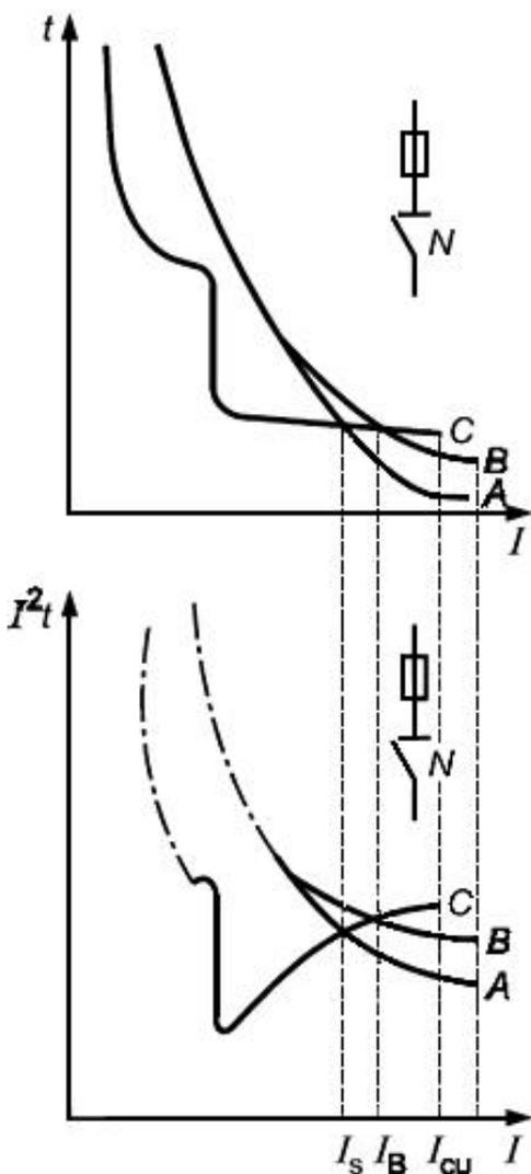
$I$  - ожидаемый ток короткого замыкания;  $I_{сн}$  - номинальная предельная наибольшая отключающая способность (5.2.4);  $I_s$  - предельный ток селективности (3.5.14.6);  $I_B$  - ток координации (3.5.14.7);  $A$  - преддуговая характеристика плавкого предохранителя;  $B$  - рабочая характеристика плавкого предохранителя;  $C$  - рабочая характеристика нетокоограничивающего выключателя ( $N$ ) (время отключения/ток и  $I^2t$ /ток).
