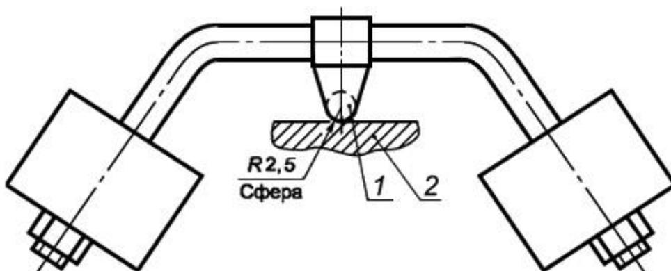
1 - стальной шарик; 2 - испытуемый образец
