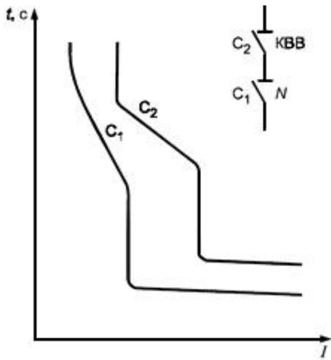
C<sub>1</sub> - нетокоограничивающий выключатель (*N*) (характеристика времени отключения); C<sub>2</sub> - выключатель с преднамеренной кратковременной выдержкой времени (КВВ) (характеристика срабатывания)
