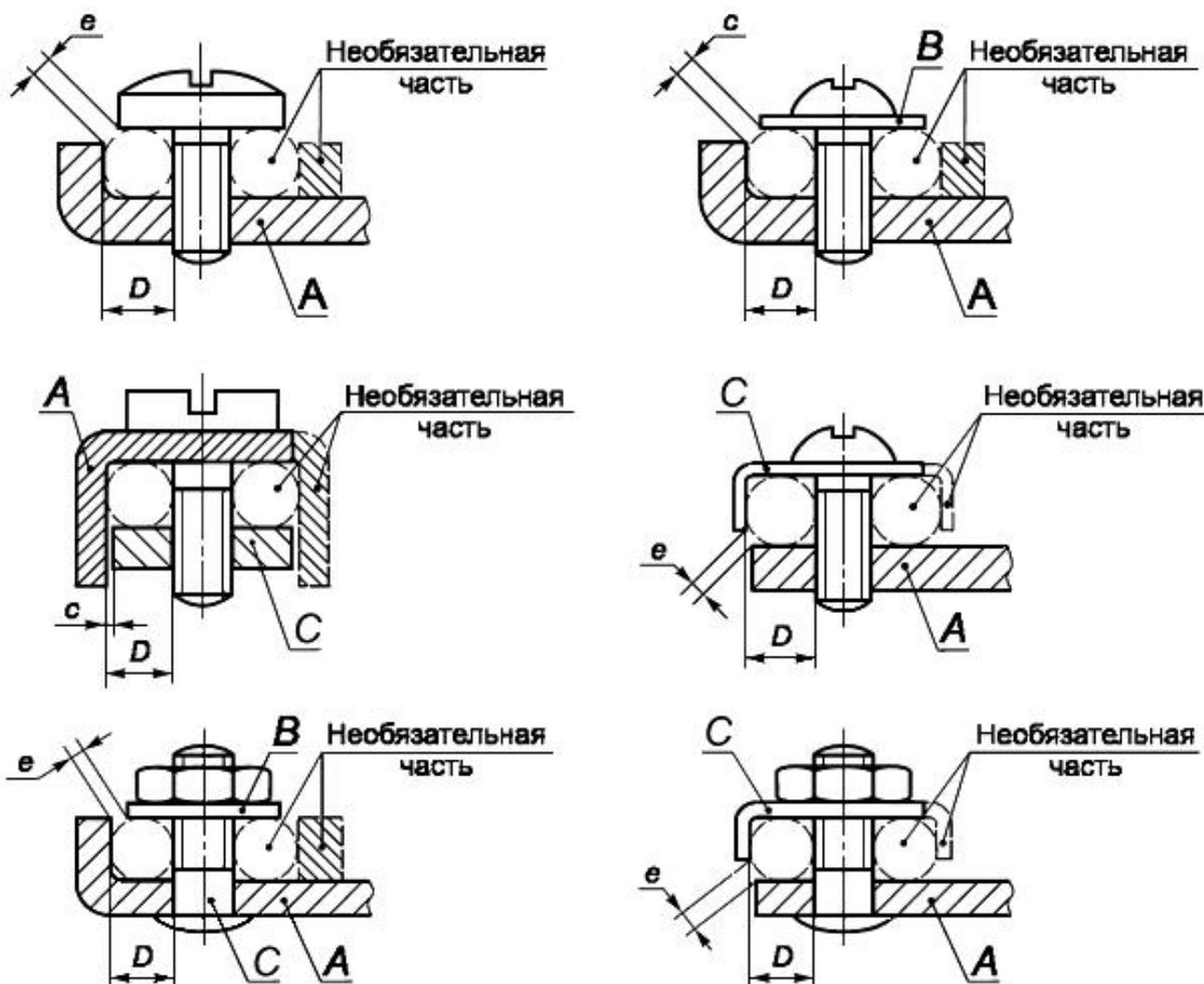
Часть, удерживающая проводник в заданном положении, может быть выполнена из изоляционного материала при условии, что давление, необходимое для зажима проводника, не передается через изоляционный материал.
