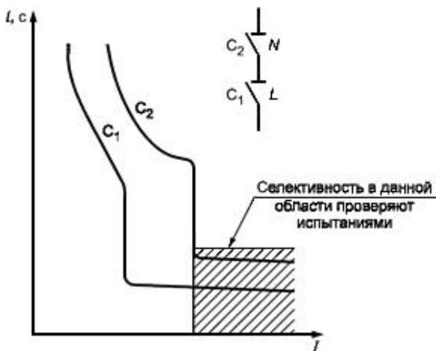
$C_1$  - токоограничивающий выключатель ( $L$ ) (характеристика времени отключения);  $C_2$  - нетокоограничивающий выключатель ( $N$ ) (характеристика срабатывания)
