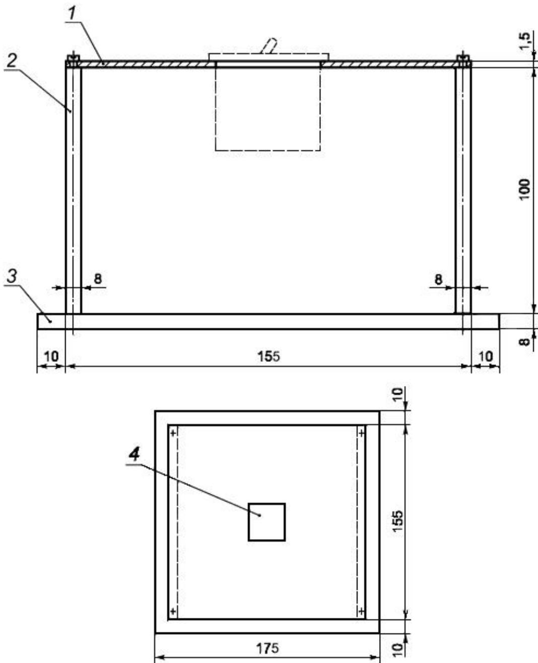
1 - съемная панель из стального листа толщиной 1,5 мм; 2 - алюминиевые листы толщиной 8 мм; 3 - монтажная панель; 4 - окно для выхода корпуса выключателя из стальной панели
